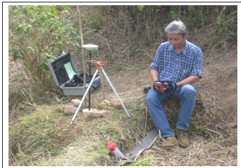
ภาพที่ 6 แสดงการตั้งเครื่องกำหนดตำแหน่งโดยใช้ดาวเทียม ที่ต้องการรู้ค่าพิกัดจำนวน 2 จุดในลักษณะ โคร่งข่ายสามเหลี่ยมในพื้นที่
