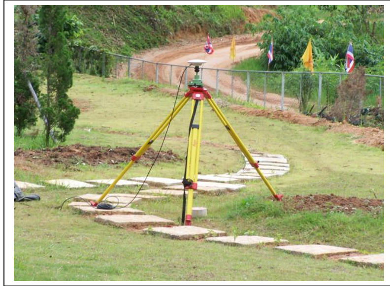
ภาพที่ 5 แสดงการตั้งเครื่องกำหนดตำแหน่งโดยใช้ดาวเทียม บนหมุดหลักฐานที่รู้ค่าพิกัดเพื่อใช้ค่าพิกัดดังกล่าวอ้างอิงในการถ่ายโอนค่าพิกัดไปยังจุดที่ต้องการ
