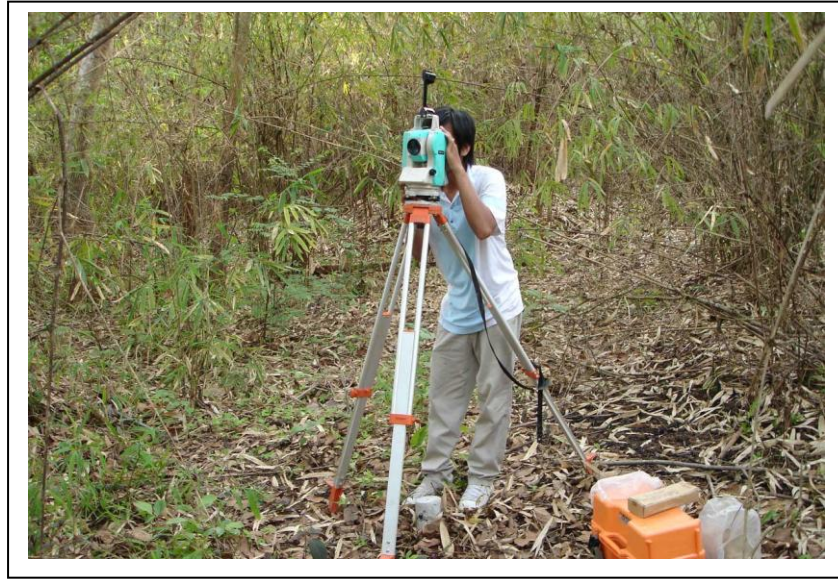
ภาพที่ 7 แสดงการสำรวจด้วยกล้องประมวลผล (Total station) เพื่อการถ่ายโอนค่าพิกัดพื้นที่จากหมุดโครงข่ายไปยังหมุดวงรอบขอบเขตพื้นที่เป้าหมายให้ครบทุกหมุด ก็จะได้ค่าตามที่ต้องการเพื่อใช้ในการสร้างแผนที่วงรอบขอบเขตและระดับต่อไป
